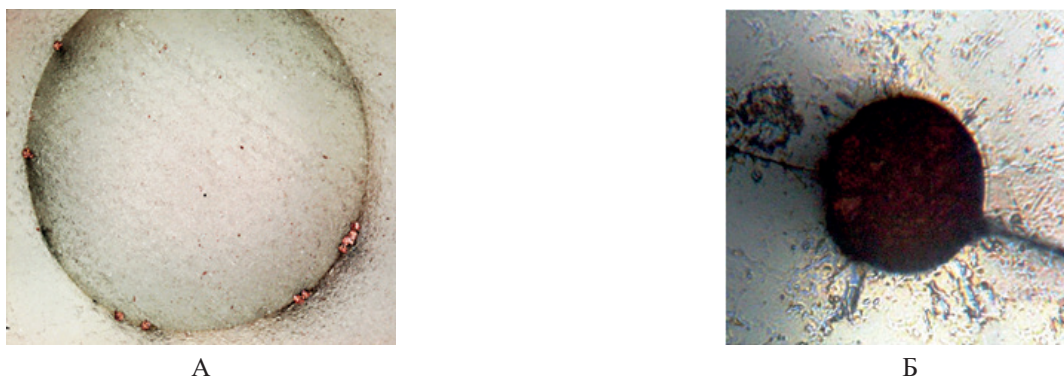
Рис. 2. Фотографии торцевой поверхности корпуса микроэлектрода (А) и впаянной медной проволоки (Б), полученные на цифровом микроскопе.
