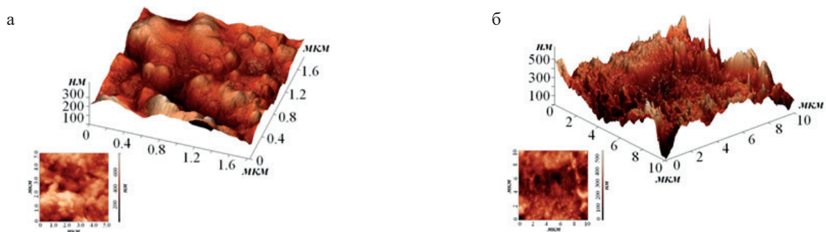
Рис. 4. Фотографии атомно-силового микроскопа поверхности медного электрода до активации (А) и после активации (Б) поверхности.
